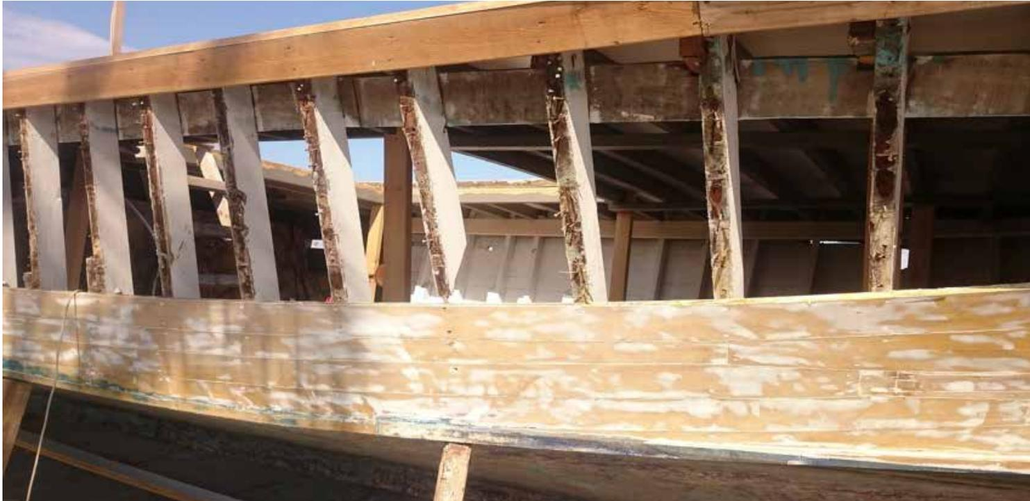
Photo 11 : Barque en construction : son intérieur est vide pour embarquer les passagers et les cargaisons.
